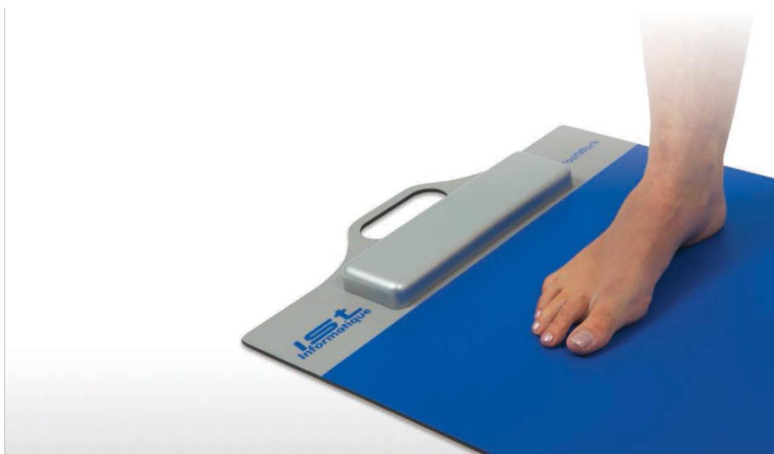
H-series压力分布测量系统设备功能（1）可在软件接口上实时显示每个感测单元的压力值；（2）可分析接触面积的压力分布状况，以二维和三维图形显示；（3）直观显示传感器各个感测单元的二维和三维图形，以蓝绿黄红等基色显示最小值至最大值图形；（4）可显示压力平均值，最大值，最小值。（5）可显示传感器的受力中心点，并可追踪中心点变化轨迹。（6）可对整个测量过程进行录制和存储，软件可导入录制的文件，重现整个测试过程。（7）可随时进行录制与停止，加载录制档案后可快进、后退、慢速播放。（8）可显示压力与时间曲线（9）可输出txt $\square$ excel等数据文文件，可输Kg/cm $^2$  $\square$ RAW $\square$ PSI $\square$ ATM $\square$ mmh $\square$ Kpa $\square$ bar等力学单位。可显示小数点后4位数值。台州压力分布测量系统多少钱R-SERIES压力分布测量系统大中华区总代理，欢迎来电洽谈！
